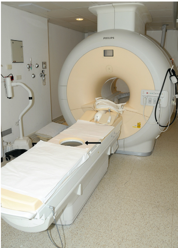
FIGUUR 1 MRI-scanner met therapeutische echotransducer ingebouwd in de tafel (pijl).
